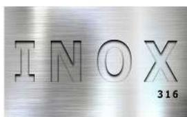
Plataforma fabricada para durar. El acero 316 se compone de una aleación que mejora la resistencia a la corrosión, especialmente para los ambientes más salinos o expuestos al cloruro. De fácil limpieza
